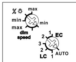
Mit dem oberen %  $\odot$ /dim-speed-Drehschalter kann entweder die Dimmgeschwindigkeit eingestellt werden oder die Mindesthelligkeit (voll abgedimmt). Mit der Dimmgeschwindigkeit wird auch die Dauer von Soft-Ein und Soft-Aus verändert.
