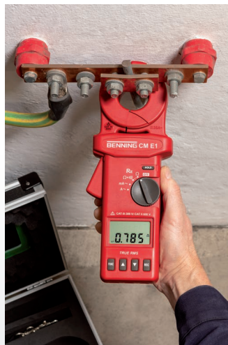
Messung des Erdschleifenwiderstandes eines Anlagenerders
