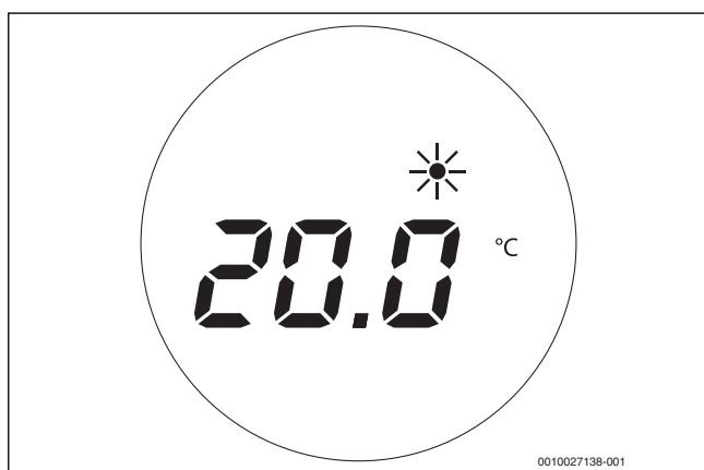
Fig. 2 Exemple en mode de fonctionnement chauffage
