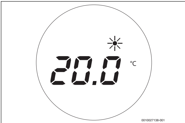
Σχ. 2 Παράδειγμα στον τρόπο λειτουργίας θέρμανσης
