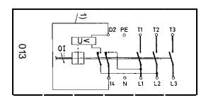
Durch Entfernen der Verbindung (14–D2) können bauseitige Elemente (Öffner) angeschlossen werden, z.B. Not-Aus-Taster
