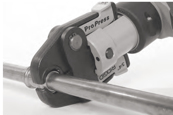
Abbildung 9 - Anbringen von Scherenbacken am Fitting
