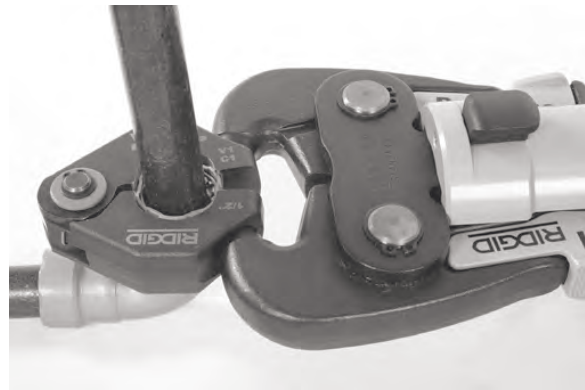
Abbildung 12 – Ansetzen des Stellantriebs am Pressring
