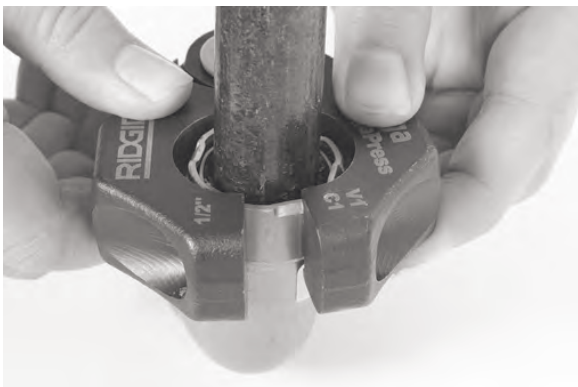
Abbildung 11 – Anbringen des Pressrings am Fitting
