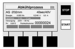
Ist die Schweißung fehlerhaft, erscheint die Meldung "Fehler" im Display. Zusätzlich wird ein akustisches und ein visuelles Signal in Form einer rot blinkenden LED ausgegeben.
