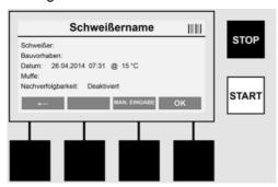
Unter dem Menüpunkt **>Schweißung<** können die erforderlichen Daten zur Schweißung eingegeben werden. Dafür kann ein Barcode mit dem Barcode Scanner eingescannt werden, oder wahlweise auch manuell mit den Multifunktionstasten.
