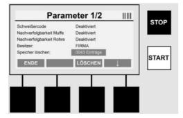
Das Gerät speichert bis zu 2.000 Schweißungen automatisch ab. Sind 2.000 Speicherplätze voll, gibt das Gerät auf dem Startbildschirm einen entsprechenden Warnhinweis aus. Weitere 47 Schweißungen werden im Überlaufspeicher gespeichert.
