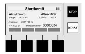
Durchmesser ..... Rohrdurchmesser laut Muffencode
