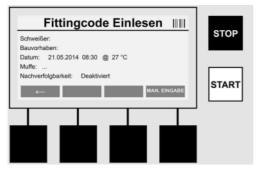
Scannen Sie mit Hilfe des Barcode Scanners den Muffencode ein. Ist der Barcode Scanner defekt oder kann der Muffencode nicht eingelesen werden, kann der Muffencode auch manuell eingegeben werden. Dazu die Taste **>Manuelle Eingabe<** drücken (siehe auch Abschnitt "Eingabe").
