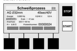
Während des Schweißprozesses werden alle relevanten Daten auf dem Display angezeigt. Der Schweißprozess wird während der gesamten Schweißzeit gemäß den durch den Muffencode vorgegebenen Schweißparametern überwacht.
