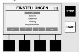
Mit den mittleren beiden Auf- und Ab-Pfeilen kann der gewünschte Menüpunkt ausgewählt werden, um dann mit dem **>Rechts-Pfeil<** zu bestätigen.
