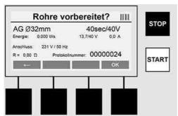
Nach erfolgreicher Dateneingabe wechselt der Bildschirm auf die Abfrage, ob die Rohre gemäß Herstellerangaben bearbeitet sind. Dies muss mit **>OK<** bestätigt werden.
