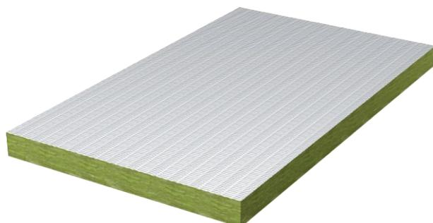
Mit Ablationsbeschichtung ASX vorbeschichtete Mineralfaserplatte als Basis für das Weichschott. 50-mm-Platte für Abschöpfung gemäß deutscher Zulassung, 60-mm-Platte für Abschöpfung gemäß europäischer Zulassung.
