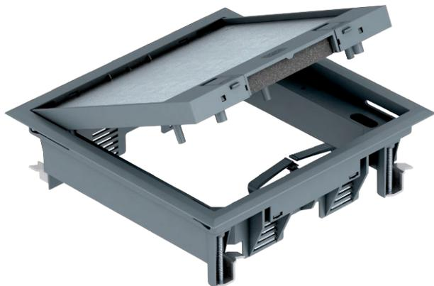
Geräteinsatz mit Rastschieber für bis zu 6 Modul 45-Einzelgeräte in 2 Universalträger UT3, Einsatz in Kanalsystemen und Systemböden im Innenbereich. Bodenbelagausparung im Klappdeckel voreingestellt auf 5 mm, bei Bedarf auch einstellbar auf 3, 8 oder 10 mm.
