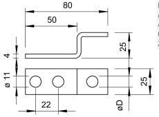
Maß D Art der Befestigungsschraube Art des Verbinders Geeignet für Verbindung Zwischenplatte 13,00 Ø mm sonstige Endstück Rundleiter Rd 8-10 / Flachleiter Fl 30
