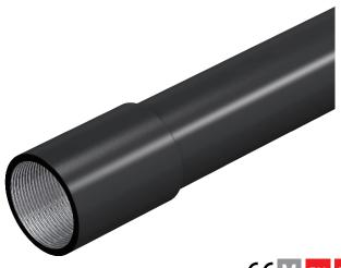
Elektroinstallationsrohr nach EN 61386-1, mit Gewindeenden nach DIN EN 60423, für den mechanischen Schutz von Kabeln und Leitungen. Mit gratfreier Innenwand. Korrosionsschutzklasse 2 (mittel). Pro Rohr ist bereits eine Verbindungsmuffe aufgeschraubt.
