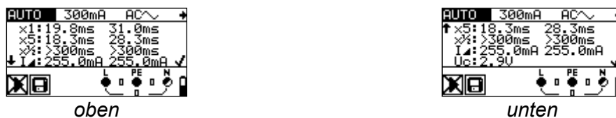
Abbildung 5.22: Die Taste HELP wechselt zwischen dem oberen und unteren Teil des Ergebnisfeldes hin und her.
