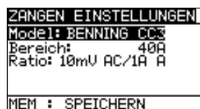
Abbildung 4.12: Einstellung des Stromzangen-Messeingangs
