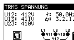
Abbildung 5.4: Beispiele für Spannungsmessungen im Einphasen- und Dreiphasensystem
