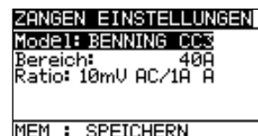
Abbildung 4.13: Einstellung des Stromzangen-Messeingangs
