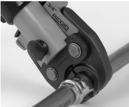
Rysunek 7 – Umieszczanie szczęk nożycowych wokół okucia
