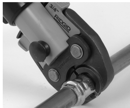
Slika 7 - Nameščanje škarjastih čeljusti okoli nastavka
