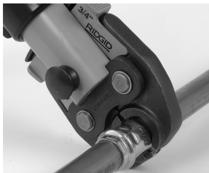
Obrázek 7 – Umístění nůžkových čelistí kolem armatury
