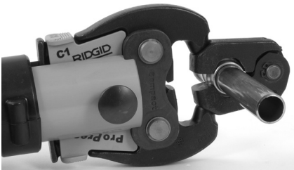
Abbildung 10 – Ansetzen der Ringbacke am Pressring
