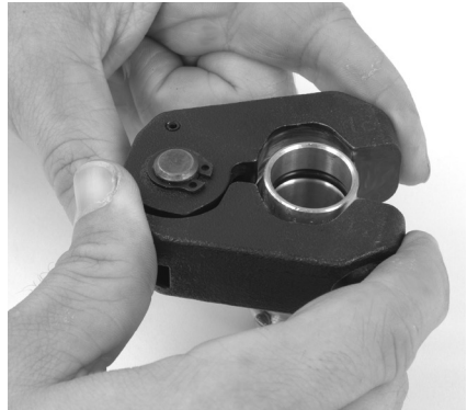
Figur 9 – Installere pressringen på utstyret
