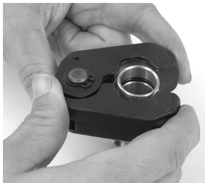
Figura 9 – Montarea inelului de presare pe fitting
