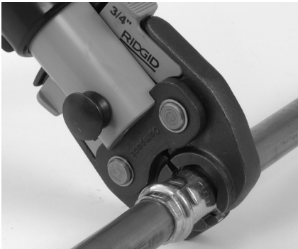
Figura 7 – Collocamento di ganasce di stile a forbice intorno al raccordo
