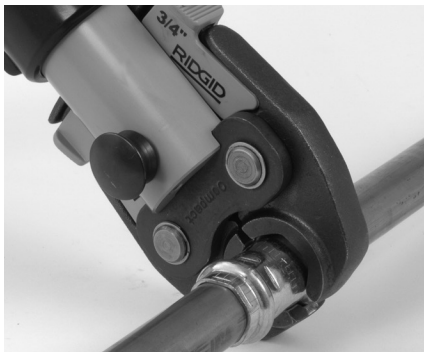
Kuva 7 – Saksityyppisten leukojen asettaminen liittimen ympärille
