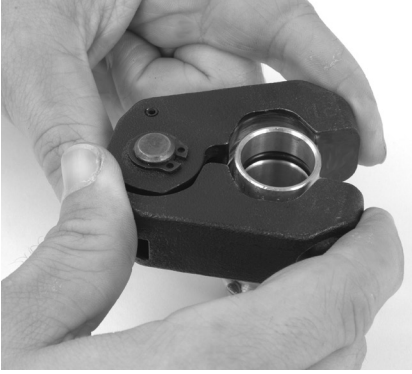
Şekil 9 – Pres Halkasının Tespit Elemanı Üzerine Takılması
