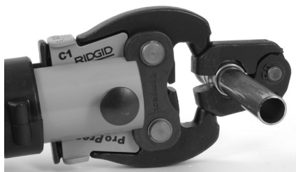
Obrázok 10 – Pripojenie akčného člena k lisovaciemu krúžku
