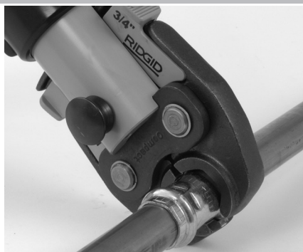
Рис. 7 – Установка пресс-клещей ножничного типа вокруг фитинга
