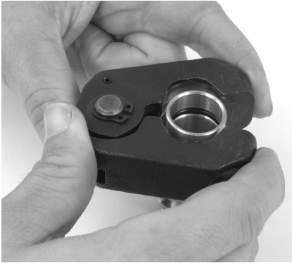
Рис. 9 – Установка обжимного кольца на фитинг
