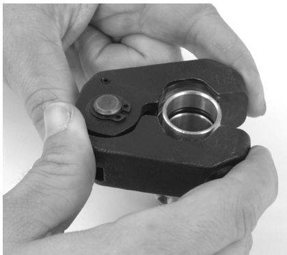
9. ábra - Présgyűrű elhelyezése a csőcsatlakozón
