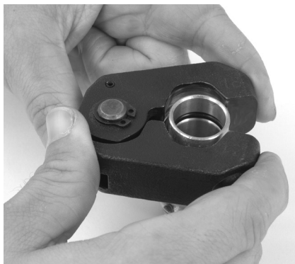
Slika 9 – Montaža prstena za prešanje na priključak
