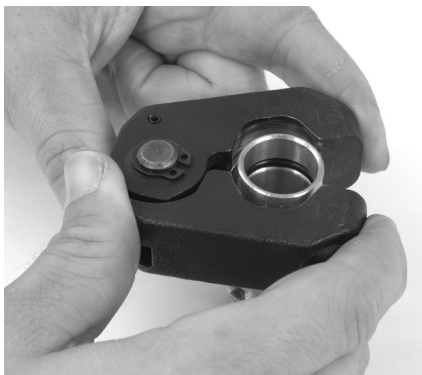
Rysunek 9 - Montaż pierścienia zaciskowego na okuciu
