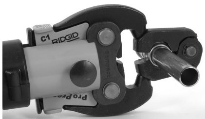
Figura 10 - Aggancio dell'attuatore all'anello di pressatura
