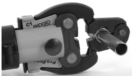
Rysunek 10 - Dołączanie siłownika do pierścienia zaciskowego
