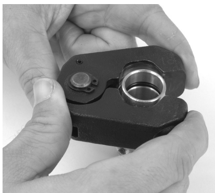
Figura 9 - Installazione dell'anello di pressatura sul raccordo
