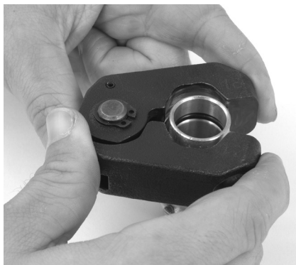
Obrázek 9 – Instalace lisovacího kroužku na armaturu
