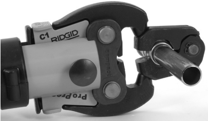
Kuva 10 – Toimilaitteen kiinnittäminen puristusrenkaaseen
