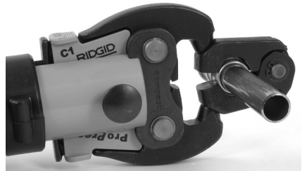
Figura 10 – Montaje del accionador en el aro sellador
