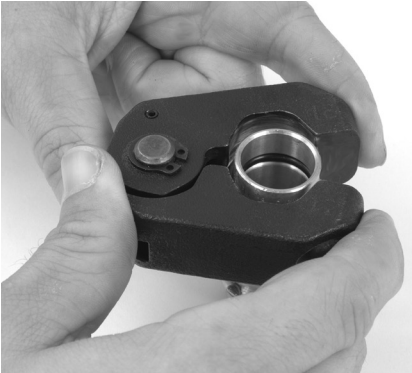
Figur 9 – Sätta dit pressringen på beslaget
