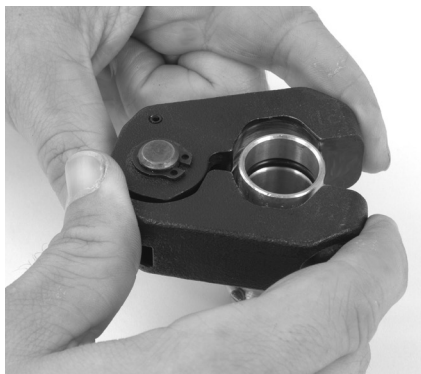
Figura 9 – Instalar o anel de prensagem no engaste
