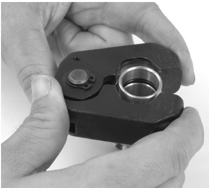
Abbildung 9 – Anbringen des Pressrings am Fitting
