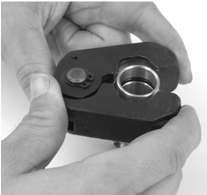
Figura 9 – Montaje del aro sellador en el acoplamiento
