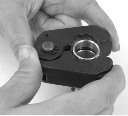
Kuva 9 – Puristusrenkaan asentaminen liittimeen
