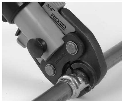
Obrázok 7 – Umiestnenie nožnicových čelustí okolo tvarovky
