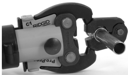
Εικόνα 10 – Σύνδεση ενεργοποιητή στον δακτύλιο πρεσαριστής σύνδεσης
