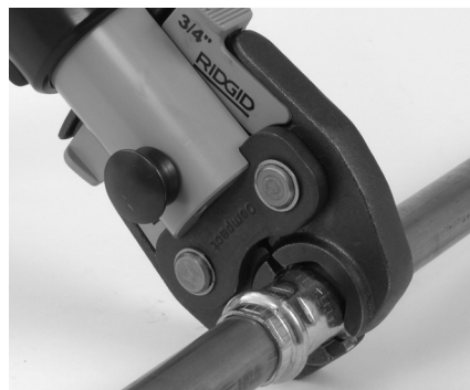
Figur 7 – Placering af saksekæber omkring fitting
