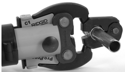
Figur 10 – Fastgørelse af aktuator på pressering
