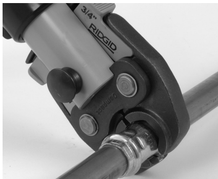
7-сурет – Қайшы тәрізді қармауыштарды фитинг айналасына орналастыру
