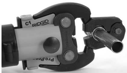
Figura 10 – Prender o atuador no anel de prensagem
