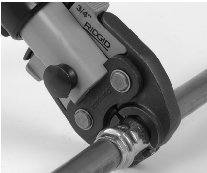
7. ábra – A szerelvény körülzárása ollós pofákkal
