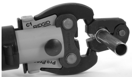
Obrázek 10 – Připojení pohonu k lisovacímu kroužku
