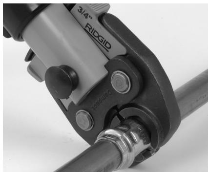
Figur 7 – Placera käftar av saxstål runt beslaget
