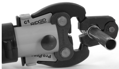
Figura 10 – Atașarea actuatorului la inelul de presare
