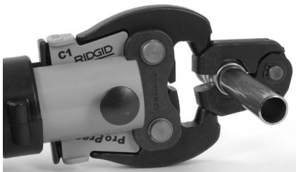
10. ábra - Működtető elem rögzítése a présgyűrűn
