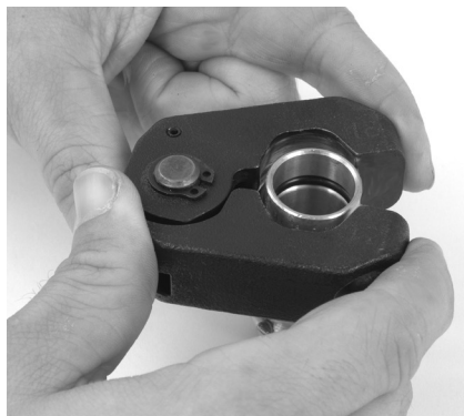
Slika 9 - Nameščanje obroča za stiskanje na nastavek
