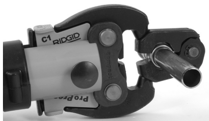
Slika 10 - Pritrjevanje sprožila na obroč za stiskanje
