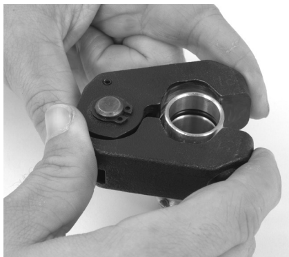
Figur 9 – Påsætning af pressering på fitting
