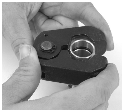
Εικόνα 9 – Τοποθέτηση δακτυλίου πρεσαριστής σύνδεσης στον σύνδεσμο
