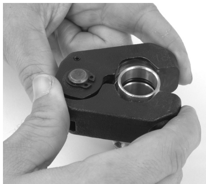
Obrázok 9 – Inštalácia lisovacieho krúžka na tvarovku
