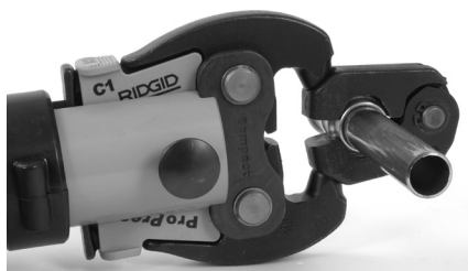
Slika 10 – Postavljanje aktuatora na prstenastu presu
