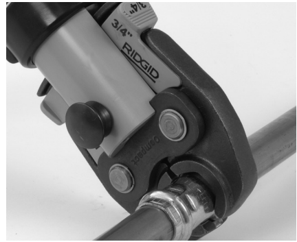
Εικόνα 7 – Τοποθέτηση σιαγόνων τύπου ψαλιδιού γύρω από τον σύνδεσμο
