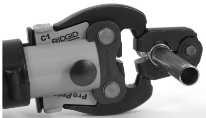
Slika 10 – Pričvršćivanje aktuatora na prsten za prešanje
