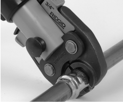
Şekil 7 – Makas Tipi Çeneleri Tespit Elemanın Etrafına Yerleştirme
