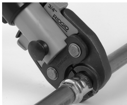
Figur 7 - Plassering av pressbakkene rundt presskoblingen
