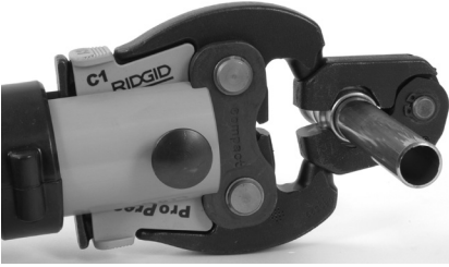
Şekil 10 – Aktuatörün Pres Halkasına Takılması
