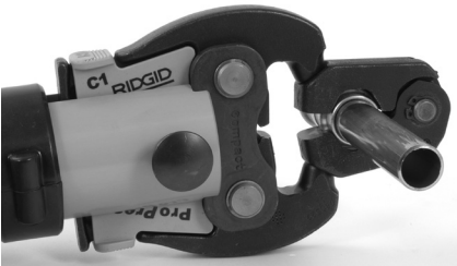
Figur 10 – Fästa aktuatoren på pressringen
