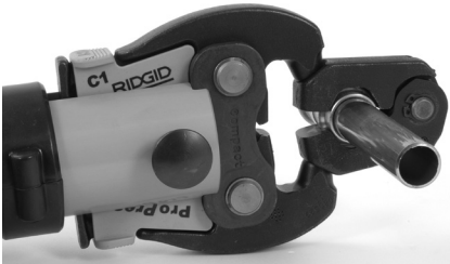
Рис. 10 – Крепление рабочей насадки на обжимном кольце
