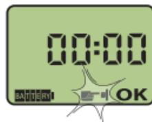
Wenn für etwa 5 Minuten keine Taste gedrückt wird, kehrt der Bewässerungscomputer automatisch auf die Seite der Uhrzeit und das Datums zurück, ohne dass die vorgenommenen Änderungen abgespeichert werden.
