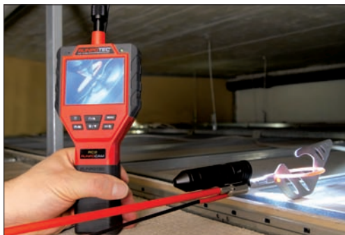
EN FAUX-PLAFONDS pour cheminer au travers des supports de plafonds
