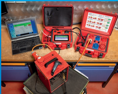
Prüfung eines 3-phasigen Heizlüfters
