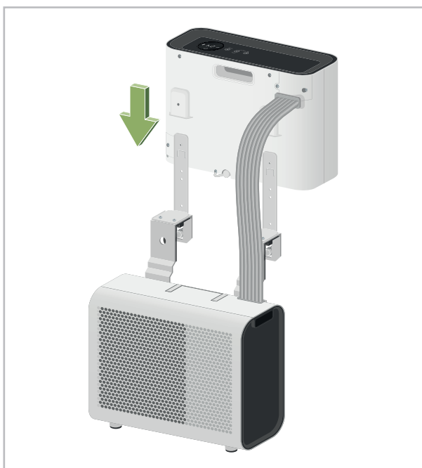
Abb. 9: Einhängen des Innengerätes
