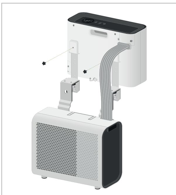
Abb. 10: Einschrauben der Sterngriffschrauben
