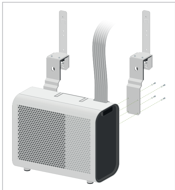
Abb. 8: Montage der Halterungen am Außenteil
