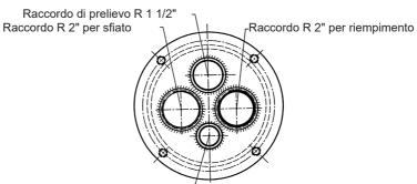
Raccordo R 1" per trasduttore di valori limite
