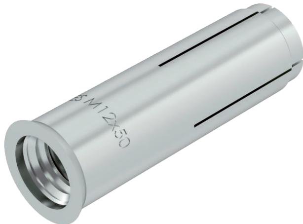
Einschlaganker zur Einzelbefestigung von nichttragenden Systemen in ungerissenem Beton und zur Mehrfachbefestigung in gerissenem und ungerissenem Beton. Brandschutztechnisch geprüft, Feuerwiderstandsklasse R 120 gemäß Europäisch Technischer Zulassung ETA-02/0020 (Opt. 7) und Europäisch Technischer Zulassung ETA-05/0116. Montage mit Markier- und Spreizwerkzeug.
