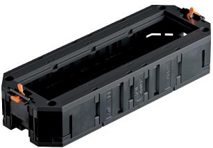
Universalträger mit zwei Zugentlastungen, Montagebrücken, Trennwand und Abdeckplatte UT4 P4 für Einbau von 4 Modul 45-Geräten in Geräteeinbaueinheiten der Nenngrößen R7, R9 und 9.
