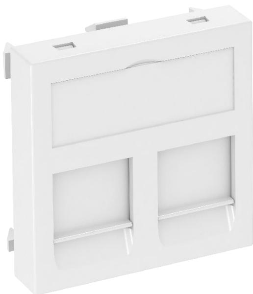
Datentechnikträger mit geradem Auslass und Verschlusschieber zur Aufnahme von zwei Datentechnik-Anschlussmodulen mit RJ45-Buchse. Die Rastbefestigung eignet sich für den waagerechten und senkrechten Einbau in die Systemumgebung. Typ B hat eine Montageöffnung von 19,35/21,55 X 14,85 mm und ist für die direkte Befestigung der Daten-Anschlussmodule in der Montageöffnung ausgelegt.
