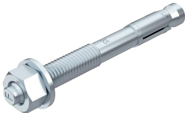
Bolzenanker BZ zur Verankerung mittelschwerer bis schwerer Lasten, sowohl im gerissenen als auch ungerissenen Beton. Er vereint hohe zulässige Lasten mit geringen Rand- und Achsenabständen.
