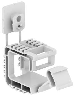
Sammelhalterung mit Befestigungslöchern 6 mm Ø für die Montage von Installationsleitungen, geeignet für Wand- und Deckenmontage. Das angespritzte Befestigungselement kann mit Schlagdübel oder Gasdrucknagelgerät befestigt werden. Der empfohlene Befestigungsabstand bei voller Belegung beträgt 50-60 cm.
