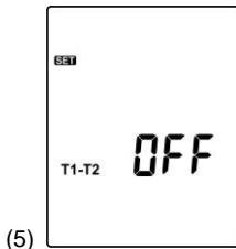
Fig.5 Einstellen T1-T2 Differenzwertanzeige.
