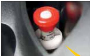
Kolbenmanometer mit eingebautem Sicherheitsventil
