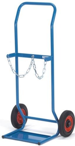
Stahlflaschenkarre aus Stahlrohr geschweißt, pulverbeschichtet blau RAL 5007. Flaschenhalterungen mit Kettensicherung. Räder mit Vollgummibereifung, Naben mit Rollenlager.
