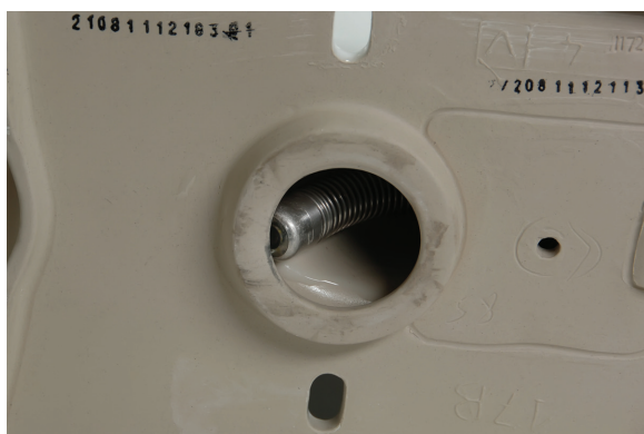
Abbildung 16 – Kamerakopf in Biegung blockiert
