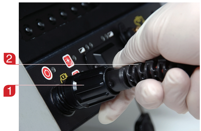
Abbildung 12 – Anschluss an ein SeeSnake CCU
