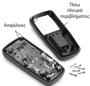
Εικόνα 9 – Αφαίρεση πίσω πλευράς του περιβλήματος πολυμέτρου
