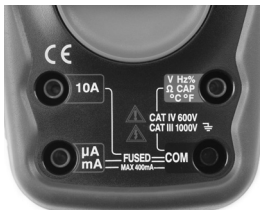
Figura 7 – Terminais de entrada
