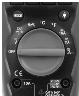
Figura 6 – Selectorul rotativ de funcții
