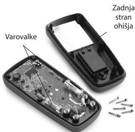
Slika 9 – Odstranjevanje zadnje strani ohišja multimetra
