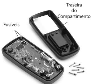
Figura 9 – Retirar a parte traseira do compartimento do multímetro
