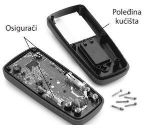
Slika 9 – Uklanjanje pozadine kućišta univerzalnog mernog instrumenta
