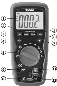
Рисунок 3 – Управление цифровым мультиметром DM-100
