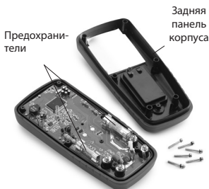
Рис. 9 – Снятие задней панели корпуса
