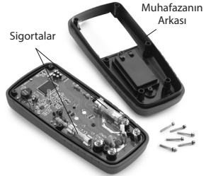
Şekil 9 – Multimetre Muhfazasının Arkasının Çıkartılması
