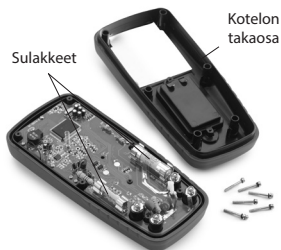
Kuva 9 – Yleismittarin kotelon takaosan irrotus
