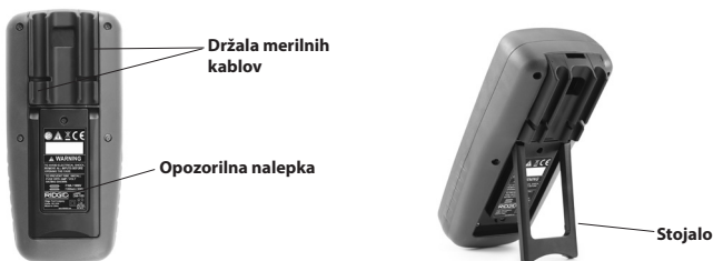
Slika 2 – Zadnja stran digitalnega multimetra micro DM-100
