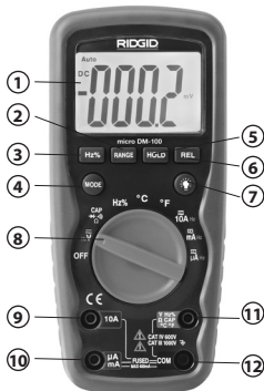
Fig. 3 – Betjeningsanordninger på det digitale multimeter DM-100
