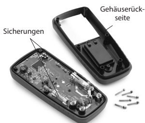
Abbildung 9 – Entfernen der Rückseite des Multimeter-Gehäuses
