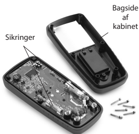
Fig. 9 – Fjernelse af bagsiden af multimeterkabinettet
