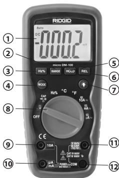
Slika 3 – Upravljački elementi DM-100 digitalnog univerzalnog mernog instrumenta
