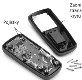
Obrázek 9 – Odstranění zadní strany krytu multimetru
