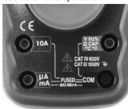
Figura 7 – Terminales de entrada
