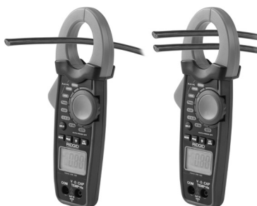
Rätt sätt vid strömmätning
