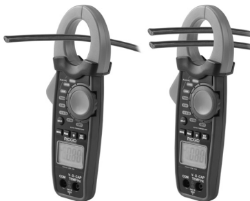
Măsurarea corectă a curentului Măsurătoarea incorectă a curentului
