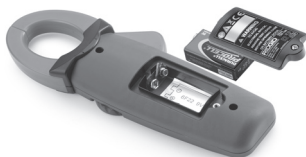
Figura 5 - Substituição da Pilha
