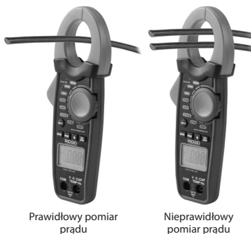
Rys. 8 – Właściwy sposób pomiaru prądu
