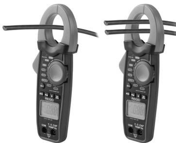
Ispravno mjerenje struje
