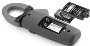
Figuur 5 – Batterij vervangen
