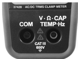
Figura 7 – Terminales de entrada
