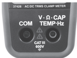
Figura 7 - Terminais de entrada
