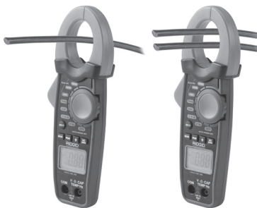
Medição da Corrente Correcta
