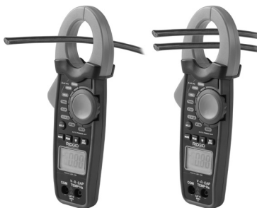
Рисунок 8 – Как правильно измерять силу тока
