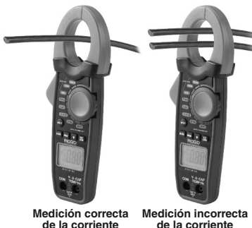
Figura 8 – Forma correcta de medir la corriente
