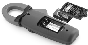
Figura 5 – Sostituzione della batteria
