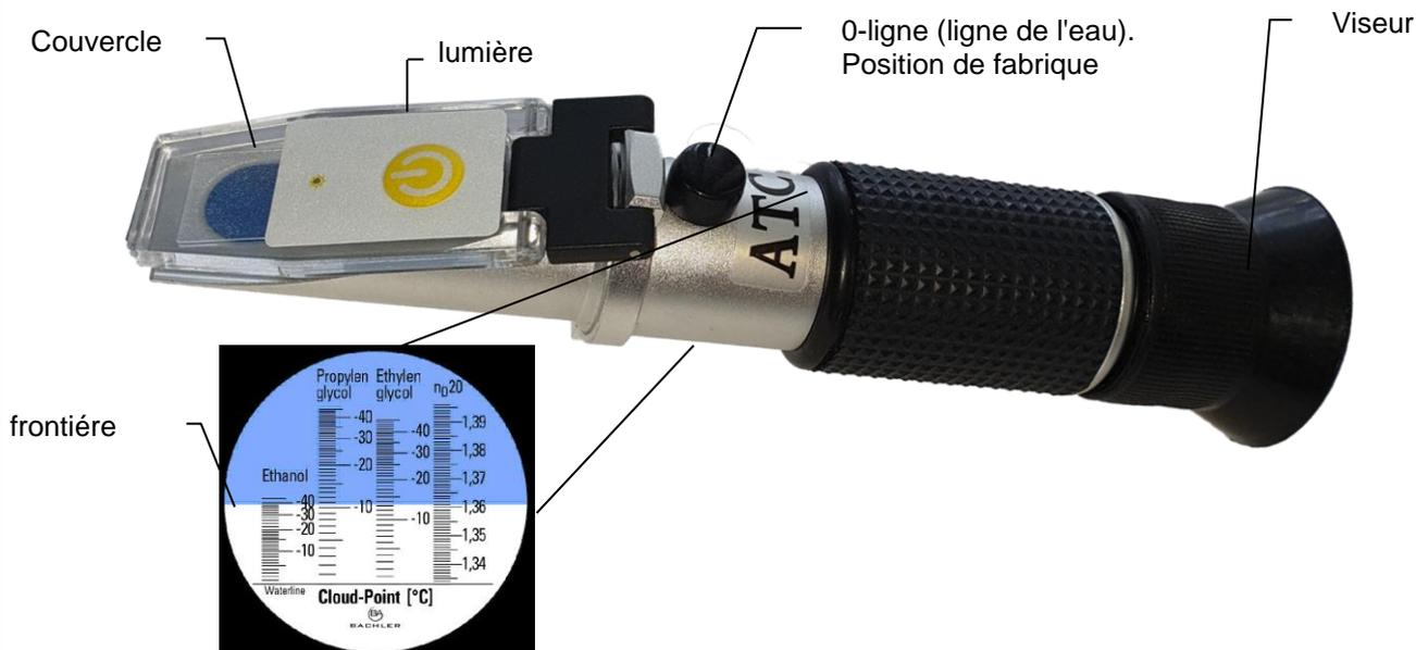
Le Refractomètre manuel définit le point de floconage de L'eau glycolée à du Propylène, de l'eau glycolée à de l'Ethylène, de l'eau mélangée à de l'Ethanol et l'index de rupture nD20 de divers fluides.
