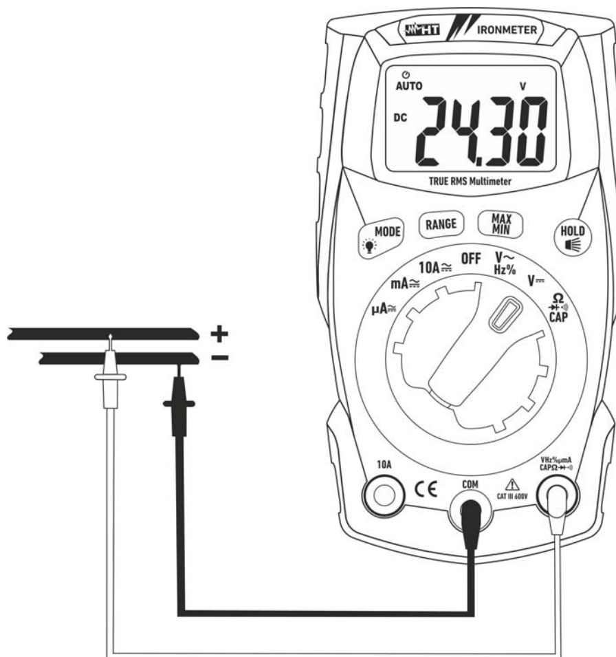
Fig. 3: Uso dello strumento per misura di Tensione DC
