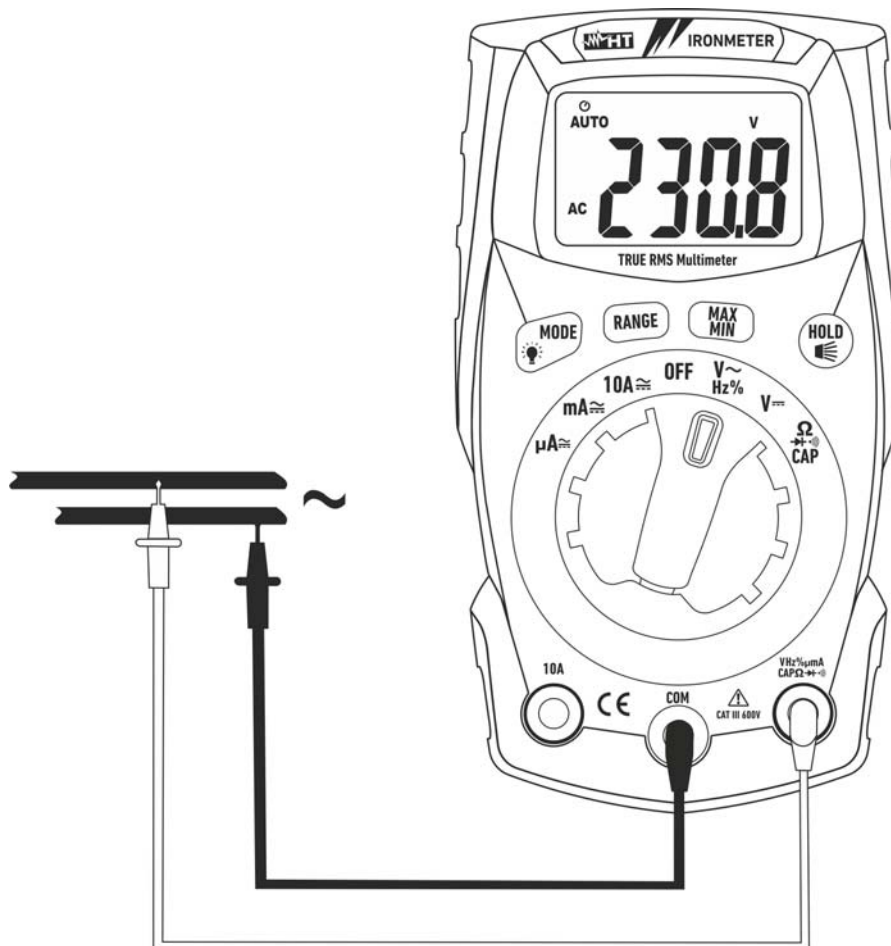
Abb. 4: Verwendung des Gerätes für Wechselspannungsmessung
