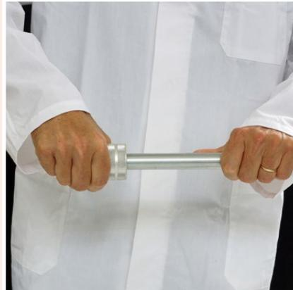
**Fig. 22** | Entgraten der Rohrenden
