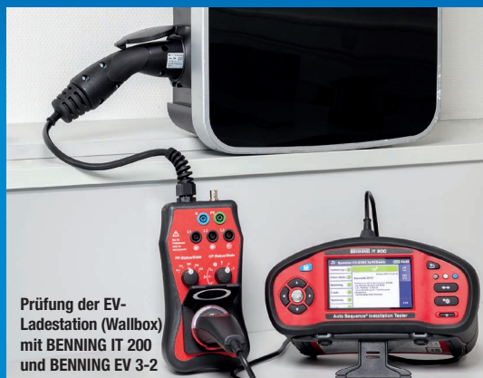
RCD-EV 30/6 mA Auto-Prüfung mit BENNING IT 200 / EV 3-2
