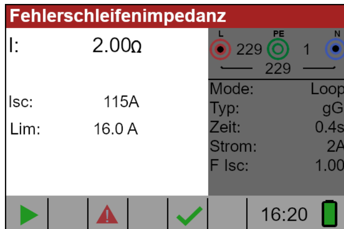
Bild 5.30: Beispiel für die Ergebnisse der Schleifenimpedanzmessung
