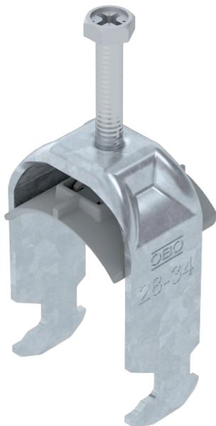
Bügel­schelle mit Hammerkopf-Fuß, Kunststoffdruckwanne aus Polypropylen. Zur vertikalen und horizontalen Montage von 1 Einzelkabel an C-Profil­schiene. Für Schlitzweite 16 - 17 mm. Mit 1-gängiger Schraube an Druckwanne, universeller Sechskant-Schraubenkopf SW10, mit Schlitz und Kreuzschlitz. Geeignet für Montage im Innen- und Außenbereich. Der Einsatz einer Gegenwanne wird empfohlen.
