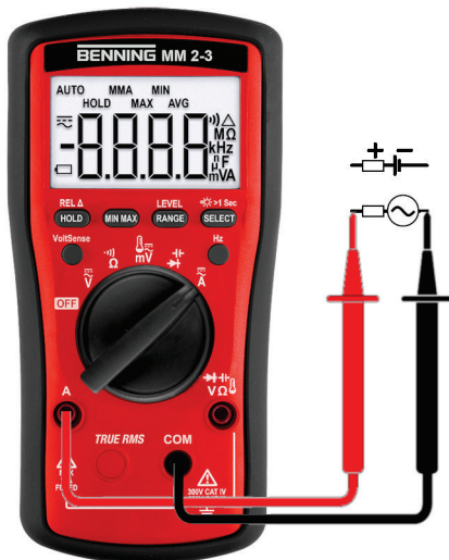
Abb. 10: Strom- oder Frequenzmessung
