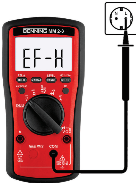
Abb. 15: Außenleiter- oder Phasenprüfung
