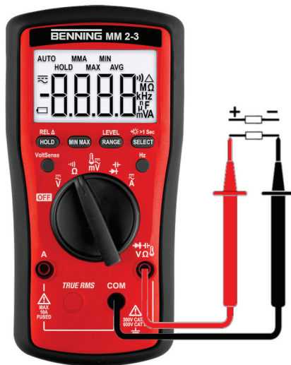
Abb. 11: Widerstandsmessung oder Durchgangsprüfung
