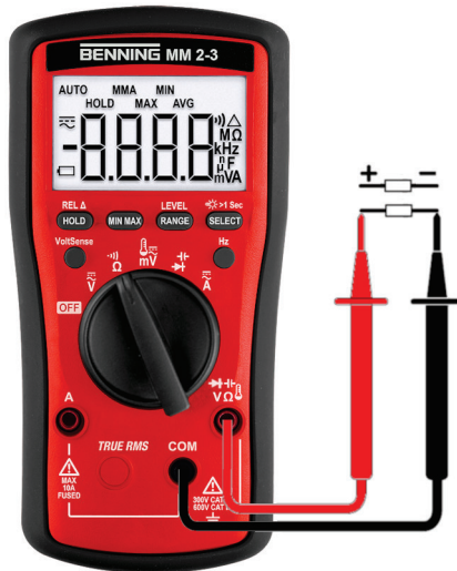
Abb. 11: Widerstandsmessung oder Durchgangsprüfung
