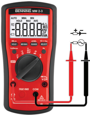
Illustration 10: Mesure de courant ou de fréquence
