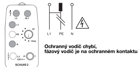
Obrázek 8: Svítí signálky N , L1 a L2 . Při dotyku elektrody GL1 svítí.
