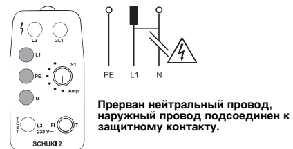
Рис. 9: Горят лампочки L1, PE и N. Контакт с электродом не производит никакого эффекта.
