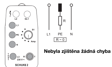
Obrázek 10: Ve žlutém pásmu svítí všechny signálky. Navíc se při stisknutí tlačítka T rozsvítí se signálka L3 . Při vypnutí chráničového ochranného spojení všechny signálky zhasnou.
