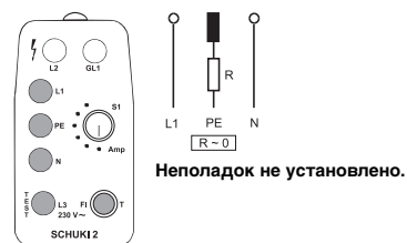
Рис. 10: Горят все лампочки в желтом диапазоне. Лампочка L3 загорается дополнительно при нажатии клавиши T . После срабатывания схемы защиты от токов повреждения все лампочки гаснут. Если схема защиты не работает, см. первую индикацию неполадки от токов повреждения.
