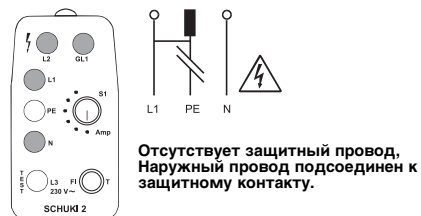
Рис. 8: Горят лампочки N, L1 и L2. GL1 загорается при прикосновении к электроду.
