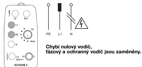
Obrázek 5: Svítí signálky L1 a PE . Žádná reakce při dotyku elektrody.
