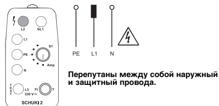
Рис. 7: Горит только лампочка L2. Контакт с электродом не производит никакого эффекта.
