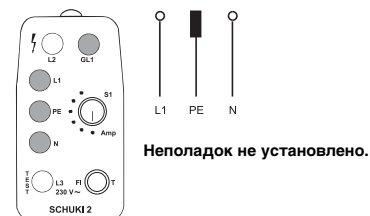
Рис. 2: Горят все лампочки в желтом диапазоне. При контакте с электродом должна гореть лампочка GL1 .
