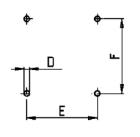
Bohrbild in der Befestigungswand Panel drilling
