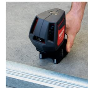
Der 360° drehbare Trockenbau-Adapter hilft, den QUBO einfach und stabil auf der Bodenschiene zu fixieren. Ganz gleich, in welche Richtung der QUBO gedreht wird, der untere Lotpunkt bleibt immer über der Schienenkante.
