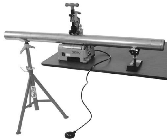
Abbildung 3 – Platzierung eines Dreibein-Untergestells
