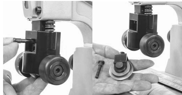
Abbildung 14 – Entfernen des Radhalters
