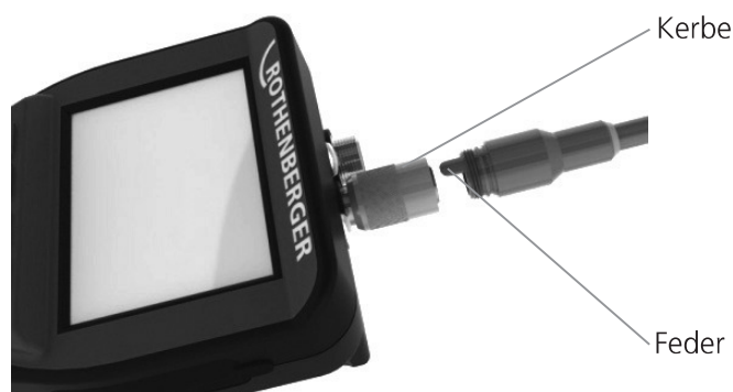
Bild 6 - Kabelverbindungen (Steckverbinder „A“, Farbe schwarz, 9-poliger Verbinder) (Zur Verwendung mit dem Modul TEC, das mit der i2000 geliefert wird und mit dem Modul 25/16)
