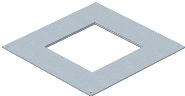
Montagedeckel für Unterflur-Zug- und -Abzweigdosen vom Typ UZD250-3 zum Einbau einer Einbaueinheit der Nenngröße 4. Einbauöffnung 3 mm vertieft zum nachträglichen Blindverschluss mit Deckelblindplatte.
