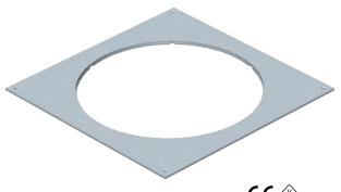
Montagedeckel für Unterflur-Zug- und -Abzweigdosen vom Typ UZD350-3 zum Einbau einer Einbaueinheit der Nenngröße R9. Einbauöffnung 3 mm vertieft zum nachträglichen Blindverschluss mit Deckelblindplatte.
