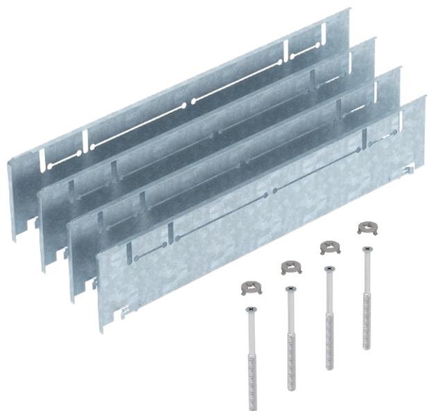
Höhenausgleich-Bausatz für Unterflurdosen UZD350-3 und UGD350-3 mit einer Bauhöhe von 70 bis 125 mm für die bauseitige Erhöhung der UZD/UGD, bestehend aus 4 Fallblechen, 4 Nivellierschrauben und 4 Drehverschlüssen.
