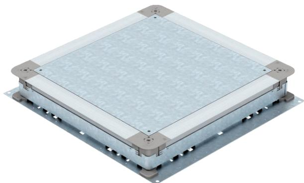
Unterflur Zug- und Abzweigdose für estrichüberdeckte Unterflur-Installationskanäle mit Seitenwänden aus Stahlblech. Zur Montage von Einbaueinheiten in Montagedeckel (separat zu bestellen). Lässt sich stufenlos auf Estrichhöhe nivellieren (Schnellnivellierung möglich) und der Estrich kann bündig an die Estrichabzugskante angearbeitet werden. Mit schalltechnischer Entkopplungsmöglichkeit nach Estrichverlegung und mit Systemzubehör auch für Schwerlastanwendung verwendbar.
