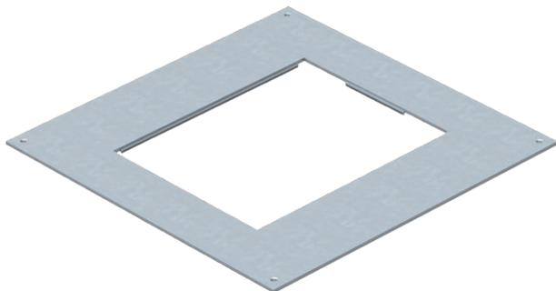
Montagedeckel für Unterflur-Zug- und -Abzweigdosen vom Typ UZD350-3 zum Einbau einer Einbaueinheit der Nenngröße 6. Einbauöffnung 3 mm vertieft zum nachträglichen Blindverschluss mit Deckelblindplatte.
