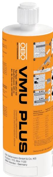
Styrenfreier Vinylester-Verbundmörtel zur spreisfreien Verankerung hoher Lasten mit Gewinde-Ankerstangen. Koaxialkartusche inklusive 1 Mischrohr, zu verarbeiten mit Auspresspistole Typ VM-P 380 Profi.
